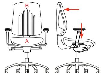
**SEAT AND BACK STATIC LOAD TEST**
